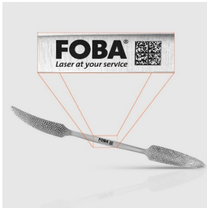
Edelstahlinstrument mit „Black Marking“. Für die Markierung wurde der Ultrakurzpulslaser FOBA F.0100-ir verwendet.
